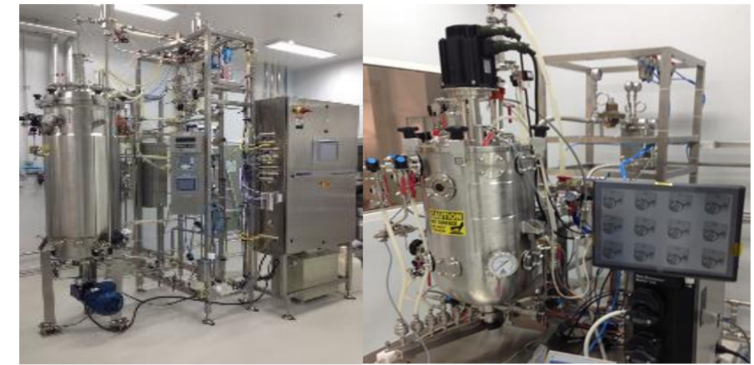
โรงงานต้นแบบชีวกระบวนการ รองรับการผลิตเอนไซม์ เพื่ออุตสาหกรรม
