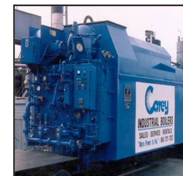
รูปที่ 4.5 หม้อไอน้ำชนิดท่อน้ำ
